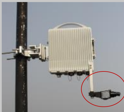
Telescope : 倍率8.3倍望遠鏡、対向アンテナの位置と合わせる
